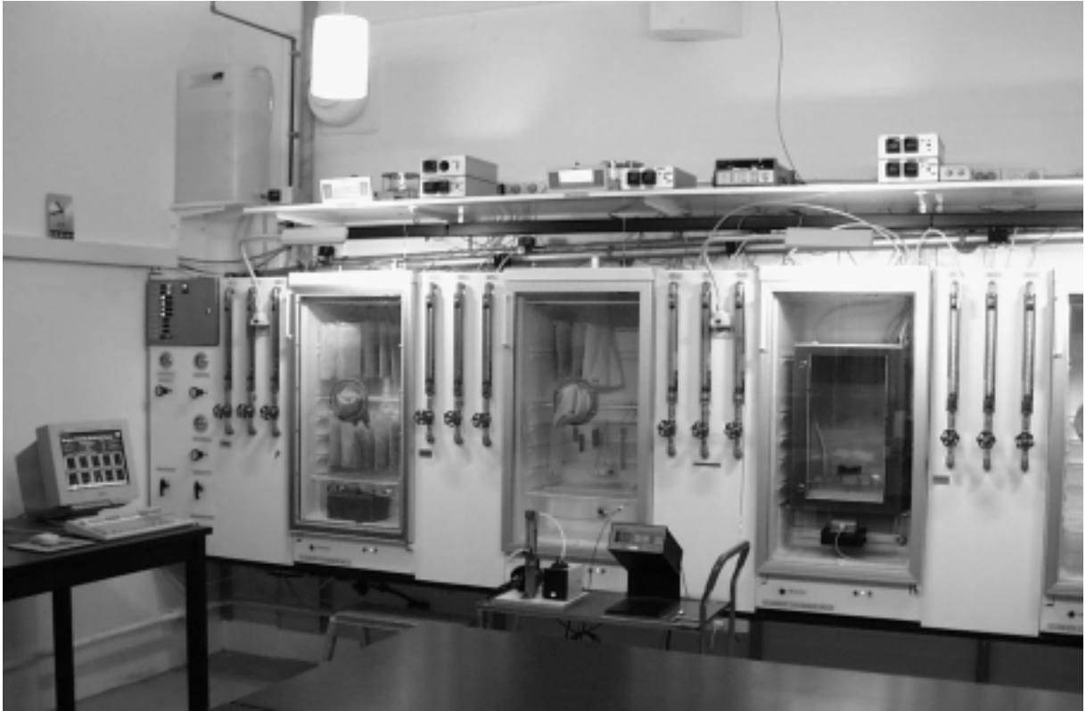
Figur 2 Klimaskabsopstilling på BKM til bestemmelse af sorptionsisotermer. De to klimaskabe til venstre benyttes til forsøg ved 20°C. Klimaskabet til højre benyttes til forsøg ved andre (højere) temperaturer, i det aktuelle tilfælde ved 40°C.
