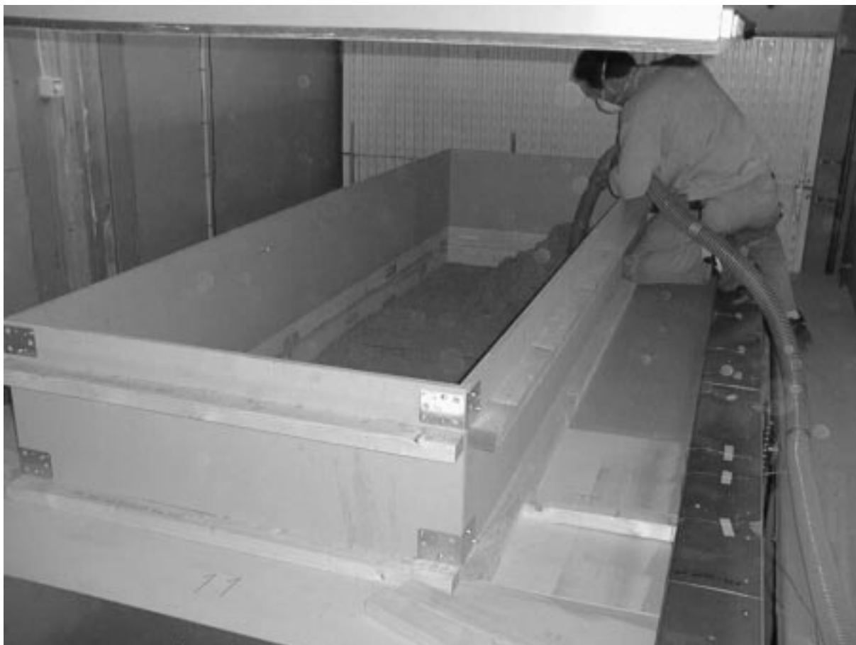
Figur 11. Foto af indblæsning af papirisolering i kasse til konvektionsmåling.
